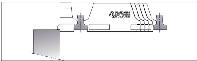
2. **Mise en oeuvre des rupteurs FABRISTOP+ d'about** pose des poutrelles, réglage de l'entraxe à l'aide du FABRISTOP+ d'about.
