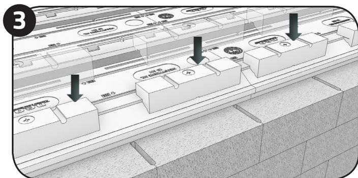
Poser les rupteurs en rive sur les Neostyrène Périf. Poser les rupteurs de rive en butée dans les rainures des Neostyrène Périf de manière à alterner des petits et grands espaces (calé à gauche, calé droite,...). Les fixer à l'aide de pointes d'ancrage.
