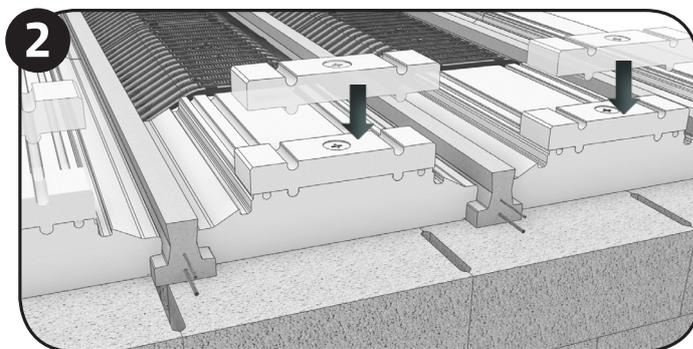
Poser les rupteurs en about sur les Neostyrène Périf et les fixer à l'aide de pointe d'ancrage.
