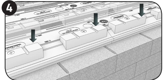
Poser les rupteurs en rive dans les rainures des Neostyrène et les fixer à l'aide de pointes d'ancrage.
