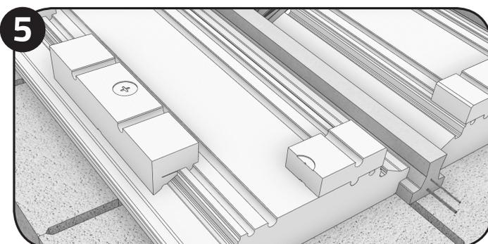
**DANS L'ANGLE** : disposer les rupteurs en fonction de la zone sismique. En zone 3 et 4, découper en deux les rupteurs.
