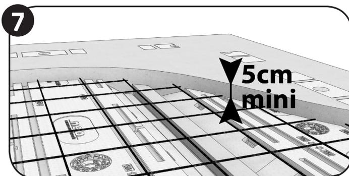
• **FERRAILAGE** : placer le treillis soudé, les aciers chapeaux, et les armatures complémentaires selon les indications du plan de pose - se référer à la partie FERRAILAGE p.3
