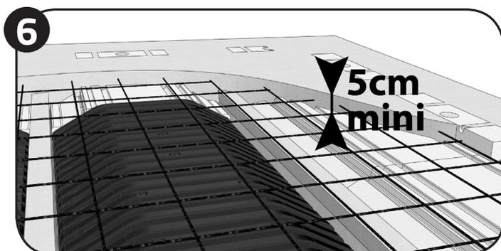
• **LE FERRAILLAGE** : placer le treillis soudé, les aciers chapeaux, et les armatures complémentaires selon les indications du plan de pose - se référer à la partie FERRAILLAGE p.3
