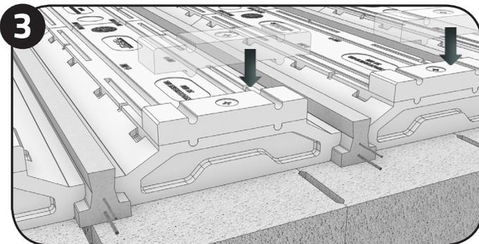
Poser les rupteurs en about et les fixer à l'aide de pointe d'ancrage.
