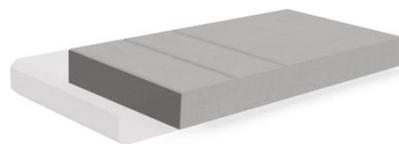
Découper la semelle du muret en suivant la rainure à l'aide d'une tronçonneuse à matériaux
