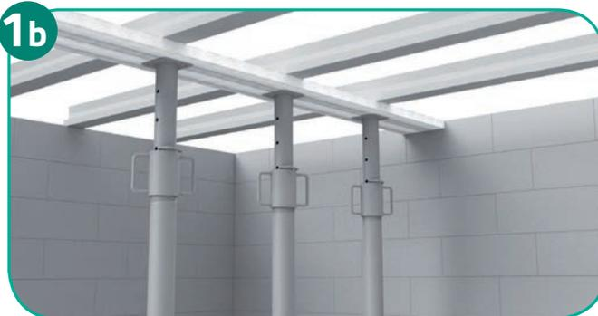
Pose des étais (selon dispositions du plan de pose). L'étalement doit être au contact de la poutrelle.
