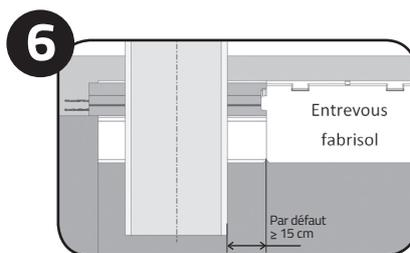
**Passage éventuel de conduit de fumée.** Réaliser un dispositif d'écart au feu conforme aux préconisations du fournisseur et selon le DTU 24-1.
