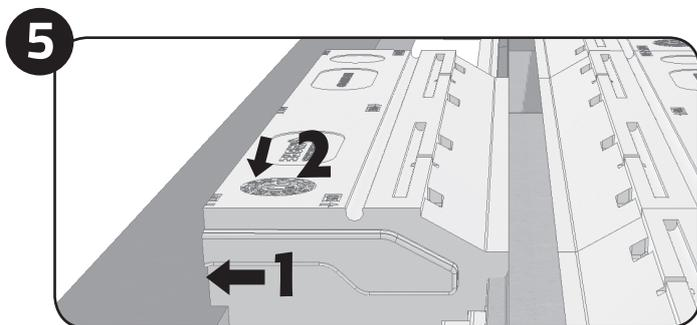
**Traitement de la dernière travée** (en cas de faux-entraxe). Découper les entrevous en respectant une distance d'appui minimum de 2 cm, puis les poser en respectant l'emboîtement. S'assurer de la sécurité lors de la pose, en prenant les dispositions nécessaires (chemin de planches, garde-corps, port des Equipements de Protection Individuels, ...)
