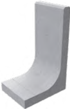
MURET DE SOUBASSEMENT Destiné à retenir de la matière (terre, matières pulvérulentes, gravats...), il évite les phénomènes d'affaissements de terrains et facilite la mise en place du drain en périphérie.
