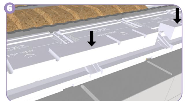
**6** Poser les rupteurs en rive sur les Neostyrène Périf. Poser les rupteurs de rive en butée dans les rainures des Neostyrène Périf de manière à alterner des petits et grands espaces (calé à gauche, calé à droite, etc.). Les fixer à l'aide de pointes d'ancrage.
