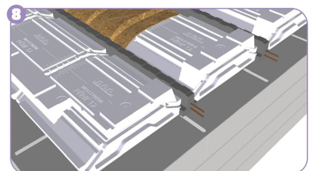
**8 DANS L'ANGLE :** disposer les rupteurs en réduisant leur longueur de moitié pour laisser le passage d'aciers filants dans l'angle.
