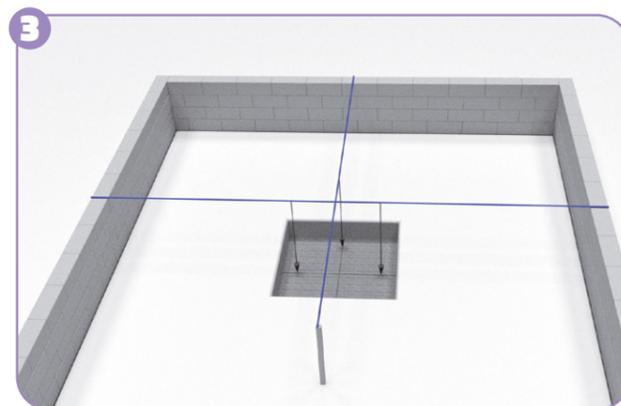
**Tracer les axes** de la semelle au cordeau sur le béton de propreté (voir plan de pose Neo). Il faut au moins 3 côtés pour mettre en œuvre la semelle.
