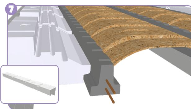
**7 EN CAS DE FAUX-ENTRAXE :** retirer la partie sécable des rupteurs de rive et les poser sur les Neostyrène Périf à 2 cm de la partie découpée. Les fixer à l'aide de pointes d'ancrage.
