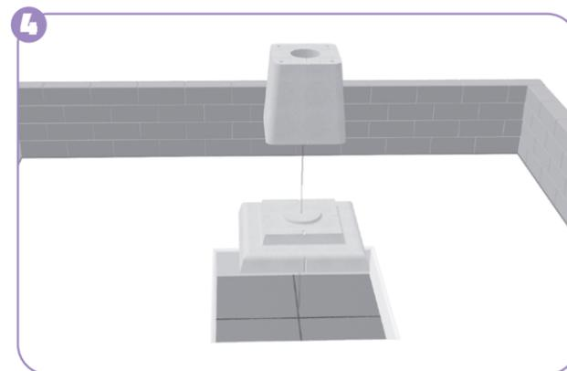
Si la portée de la grue le permet, **installer la semelle, puis le plot**. Sinon, poser les 2 éléments séparément. Afin de faciliter la mise en œuvre, utiliser le gabarit de pose.
