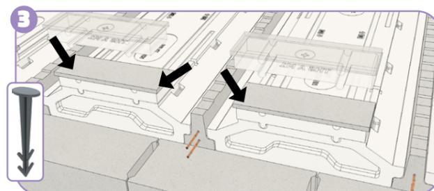
Poser les rupteurs feu en about et les fixer à l'aide de pointes d'ancrage dans la partie en polystyrène aux extrémités du rupteur.
