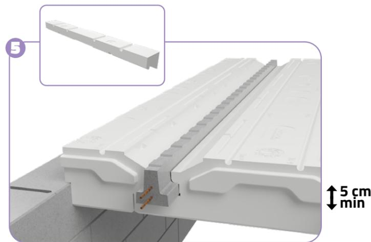
**EN CAS DE FAUX-ENTRAXE :** retirer la partie sécable des rupteurs de rive et les poser sur les Fabrisol à 2 cm de la partie découpée. Afin de respecter les espacements entre les rupteurs, les aligner par rapport aux nervures de l'entrevous. Les fixer à l'aide de pointes d'ancrage.
