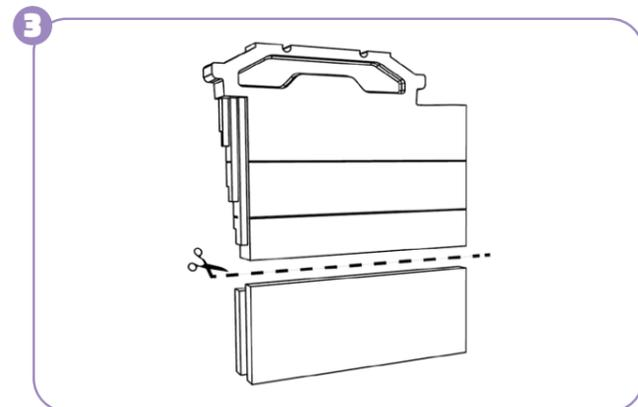
3 Associé à une poutre PPR, PSR 20x20, PR 20x30 le Fabrifend s'adapte par simple découpe, en glissant une partie découpée sous la poutre.
