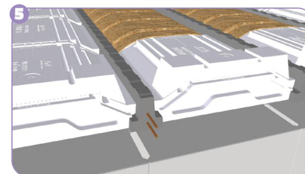
**5** Poser les rupteurs en about sur les Neostyrène Périf et les fixer à l'aide de pointes d'ancrage.
