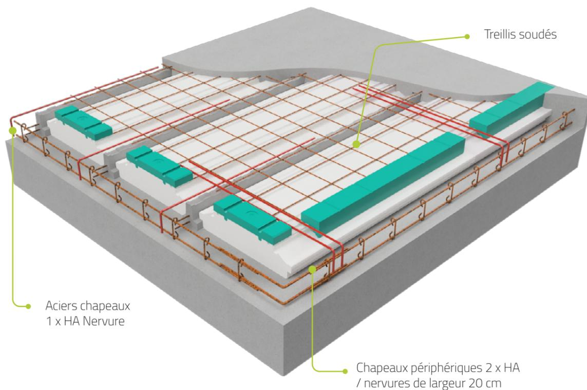
Le schéma ci-dessus représente les dispositions spécifiques relatives à l'utilisation de rupteurs thermiques en zone sismiques 1 et 2.
