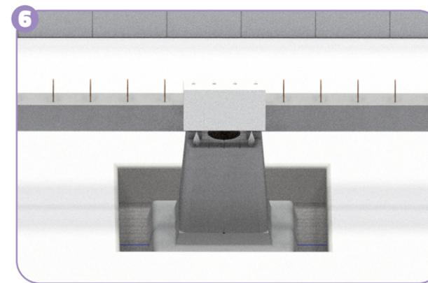
Insérer les **Connecteurs Neo dans les plots et les coffrages PSE** dans les Connecteurs Neo. Découper si besoin le coffrage afin de l'aligner à l'arase supérieure de la poutre.
