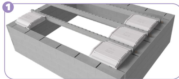
**1 RÉALISER L'ENTRAXE DES POUTRELLES :** poser sur la première travée de rive un Neostyrène Périf à chaque extrémité de la travée.
