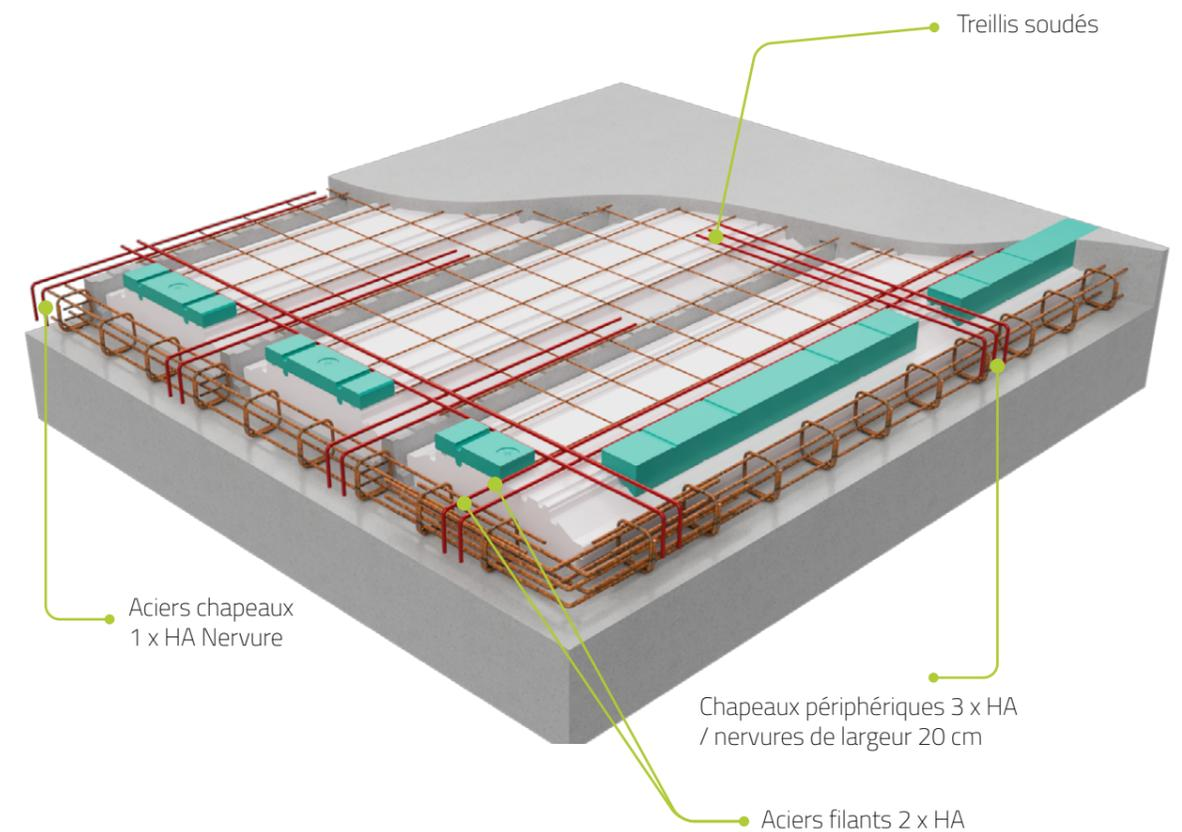
Le schéma ci-dessus représente les dispositions spécifiques relatives à l'utilisation de rupteurs thermiques en zone sismiques 3 et 4.
