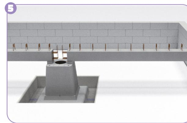
Si besoin et en fonction de votre configuration, **régler l'altimétrie grâce aux cales béton** (maxi 2 cales superposées). (Voir annexe du Configérateur Refend). Dans le cas d'un montage poutre sur parpaing, insérer un lit de mortier entre les deux de 7 cm minimum.
