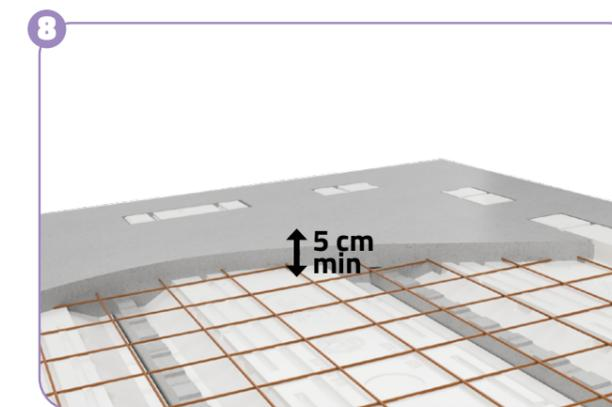
8 **FERRAILLAGE** : placer le treillis soudé, les aciers chapeaux et les armatures complémentaires selon les indications du plan de pose.
