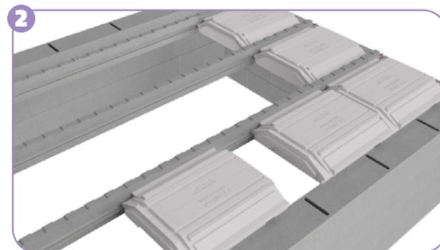
**2 POSE DES ENTREVOUS - TRAVÉE DE RIVE (1<sup>ÈRE</sup> TRAVÉE) :** poser les Neostyrène Périf sur toute la longueur de la travée en respectant l'emboîtement. En fin de travée, découper si besoin le dernier Neostyrène Périf afin d'ajuster sa longueur.
