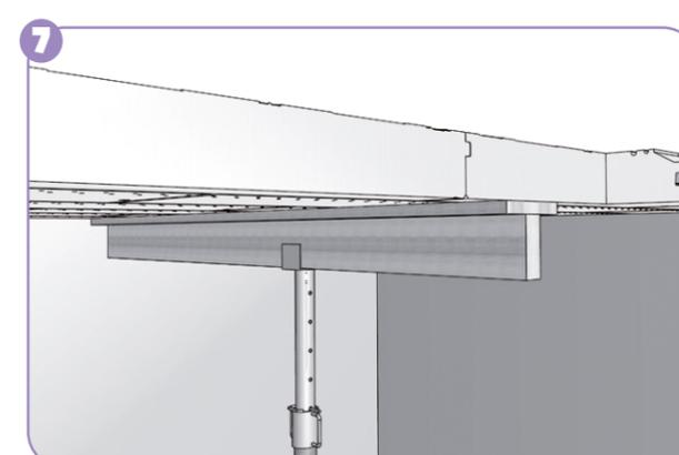
**POSE DES ÉTAIS** (selon dispositions du plan de pose) : pour protéger la sous-face des entrevous, placer une planche de **largeur  $\geq 25$  cm** entre le bastaing supérieur et la languette de l'entrevous.
