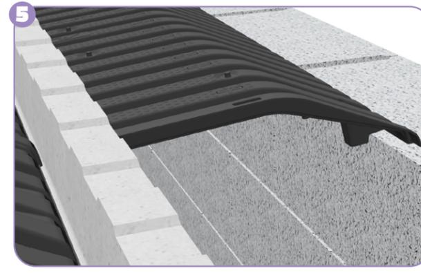
**5 DANS LE CAS D'UN FAUX-ENTRAXE** : découper l'entrevous dans le sens de la longueur. Dans le cas d'un faux-entraxe contre un mur, poser le côté découpé contre une poutelle et les butées du côté du mur afin d'éviter le glissement de l'entrevous.
