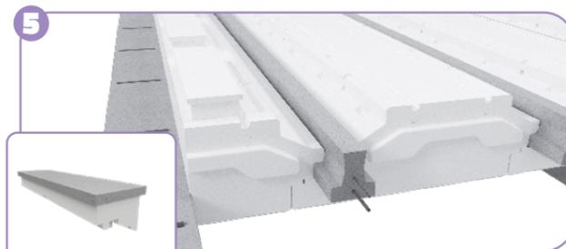
**EN CAS DE FAUX-ENTRAXE :** retirer la partie sécable des rupteurs de rive et les poser sur les Fabrisol M1 Décor à 2 cm de la partie découpée. Afin de respecter les espacements entre les rupteurs, les aligner par rapport aux nervures des Fabrisol M1 Décor.
