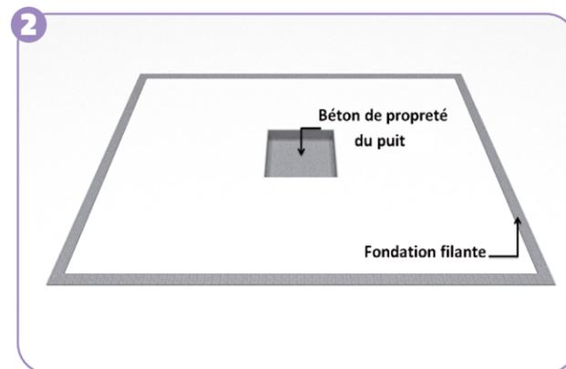
**COULAGE DU BÉTON DE PROPRETÉ :** respecter la différence de niveau notée sur l'annexe du Configérateur Refend (différence entre le dessus de la fondation filante et le dessus du béton de propreté).
