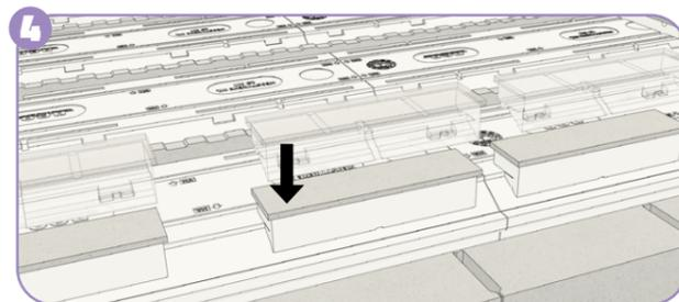
Poser les rupteurs en rive dans les rainures des Fabrisol M1 Décor et les fixer à l'aide de pointes d'ancrage dans la partie en polystyrène sur les côtés du rupteur.
