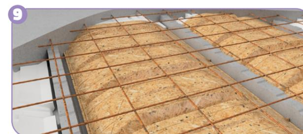
**9 FERRAILLAGE :** placer le treillis soudé, les aciers chapeaux et les armatures complémentaires selon les indications du plan de pose.
