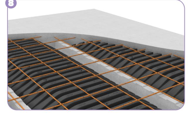
**8 FERRAILLAGE** : placer le treillis soudé, les aciers chapeaux et les armatures complémentaires selon les indications du plan de pose.
