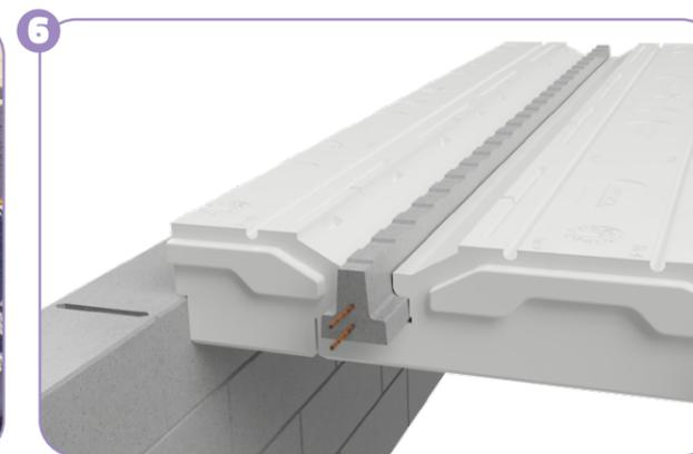
6 **DERNIÈRE TRAVÉE DANS LE CAS D'UN FAUX-ENTRAXE** : découper l'entrevous sur la longueur afin de conserver l'épaulement contre la poutrelle et les réservations spécifiques à l'emboîtement des rupteurs. Associer les deux parties de l'entrevous grâce aux connecteurs Fabrisol.
