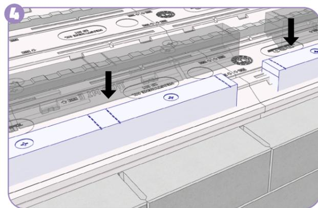
Poser les rupteurs en rive dans les rainures des Neostyrène ou du Fabrisol et les fixer à l'aide de pointes d'ancrage.
