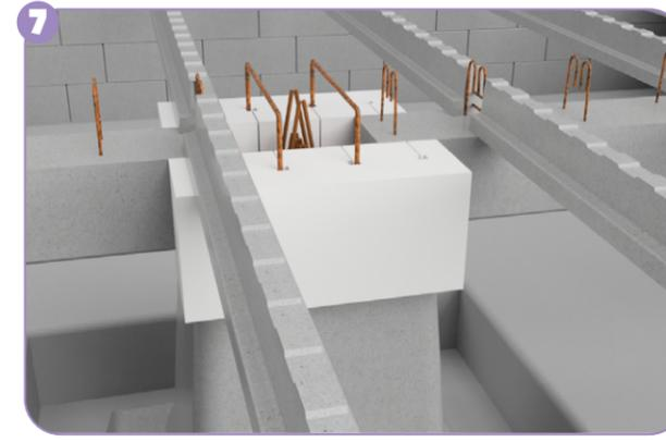
Dans le cas d'une mise en œuvre avec un entrevous sans languette, s'assurer du maintien du **coffrage PSE** en partie supérieure afin de maintenir l'étanchéité lors du coulage.
