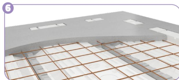
**FERRAILLAGE :** placer le treillis soudé, les aciers chapeaux et les armatures complémentaires selon les indications du plan de pose.
