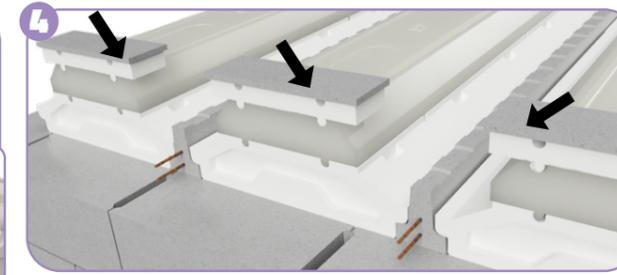
**POSER LES RUPTEURS NEOSSET FEU ABOUT SUR LA REHAUSSE :** utiliser les pointes d'ancrage pour les fixer.
