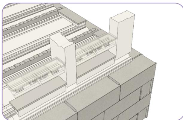
Poser les rupteurs en rive sur les Neostyrène Coffrant. Démarrer la pose des rupteurs de rive à 20 cm de l'extrémité de l'entrevous puis alterner un espacement entre rupteurs de 10 cm et 20 cm à l'aide des cales en polystyrène présentes sur les palettes. Les fixer sur les côtés à l'aide de pointes d'ancrage.
