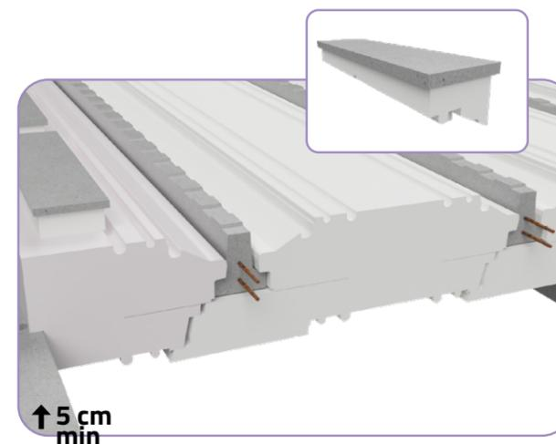
**EN CAS DE FAUX-ENTRAXE :** retirer la partie sécable des rupteurs de rive et les poser sur les Neostyrène Coffrant à 2 cm de la partie découpée.
