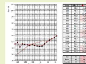
Le bureau d'études Neo dispose d'un outil acoustique certifié CERIB permettant de réaliser les prédictions acoustiques sur la base des règles de calcul de la norme NF P19-205 présente dans le DTU. Ces normes traitent les ouvrages courants. Il définit les valeurs les valeurs  $R_w$  et  $L_{nw}$  de nos planchers.
