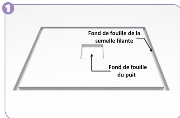
**RÉALISATION DU OU DES PUIITS :** en fonction de votre plan de pose d'une dimension mini de 1,40 m x 1,40 m. Le fond de fouille de chaque puit doit impérativement se situer à la même profondeur que la semelle filante en périphérie.
