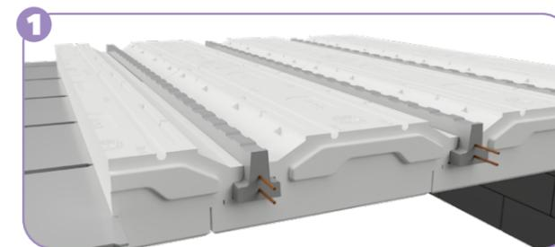
**1ÈRE TRAVÉE POSÉE SUR LE MUR :** découper l'entrevous sur la longueur pour enlever la partie en biais et le poser sur le mur.
