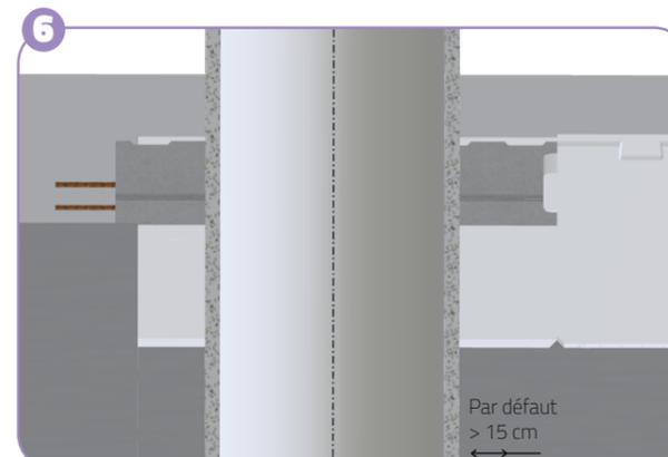
**PASSAGE ÉVENTUEL DE CONDUIT DE FUMÉE :** réaliser un dispositif d'écart au feu conforme aux préconisations du fournisseur et selon le DTU 24-1.
