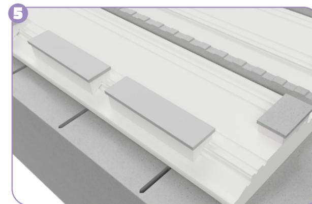
**DANS L'ANGLE :** découper en deux le rupteur d'about.
