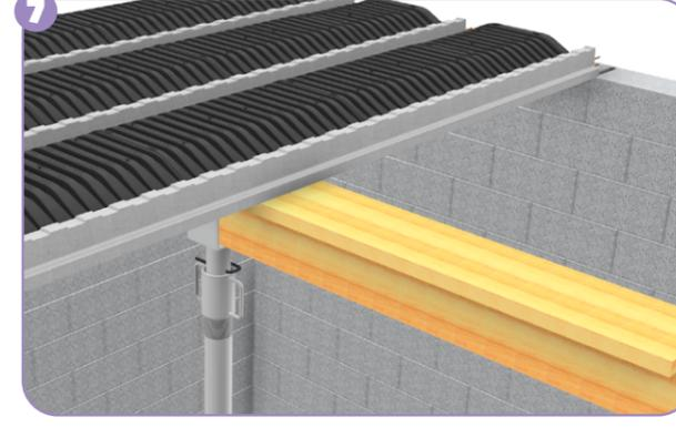
**7 POSE DES ÉTAIS** (selon dispositions du plan de pose). L'étalement doit être au contact de la poutelle.
