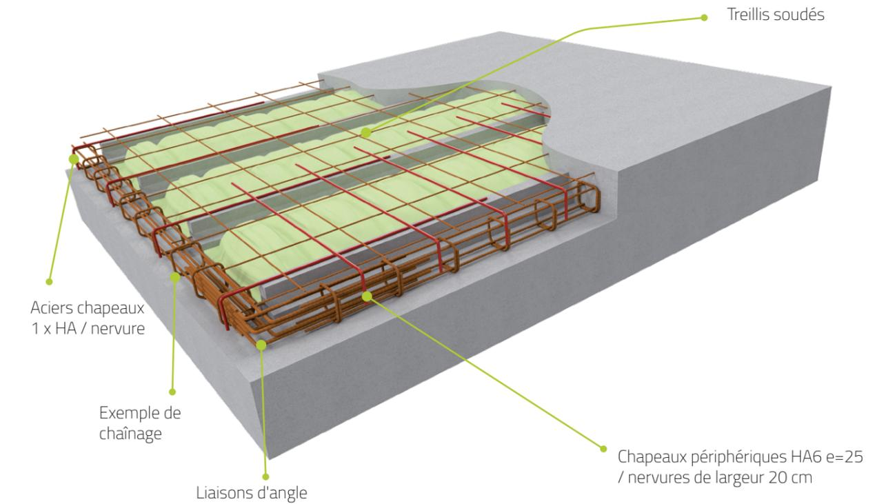
Le schéma ci-dessus représente les dispositions spécifiques relatives **sans l'utilisation de rupteurs thermiques** en zones sismiques 3 et 4.
