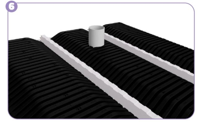
**6 PASSAGE ÉVENTUEL DE CONDUIT DE FUMÉE** : réaliser un dispositif d'écart au feu de 15 cm minimum selon les préconisations du DTU24-1.
