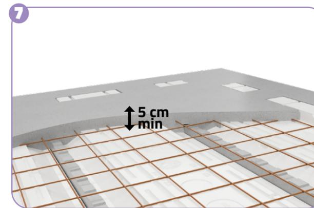
**FERRAILLAGE :** placer le treillis soudé, les aciers chapeaux et les armatures complémentaires selon les indications du plan de pose.
