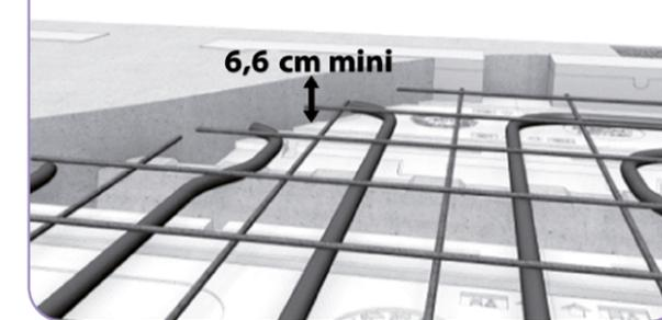
**FERRAILLAGE** : placer le treillis soudé, les aciers chapeaux et les armatures complémentaires selon les indications du plan de pose.
