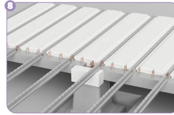
Poser le plancher suivant le plan de pose. Au niveau du clavetage, la poutrelle se pose sur le **coffrage PSE** sans disposition particulière. Le coulage du plancher, le clavetage des poutres et le remplissage des plots se font en une seule opération.
