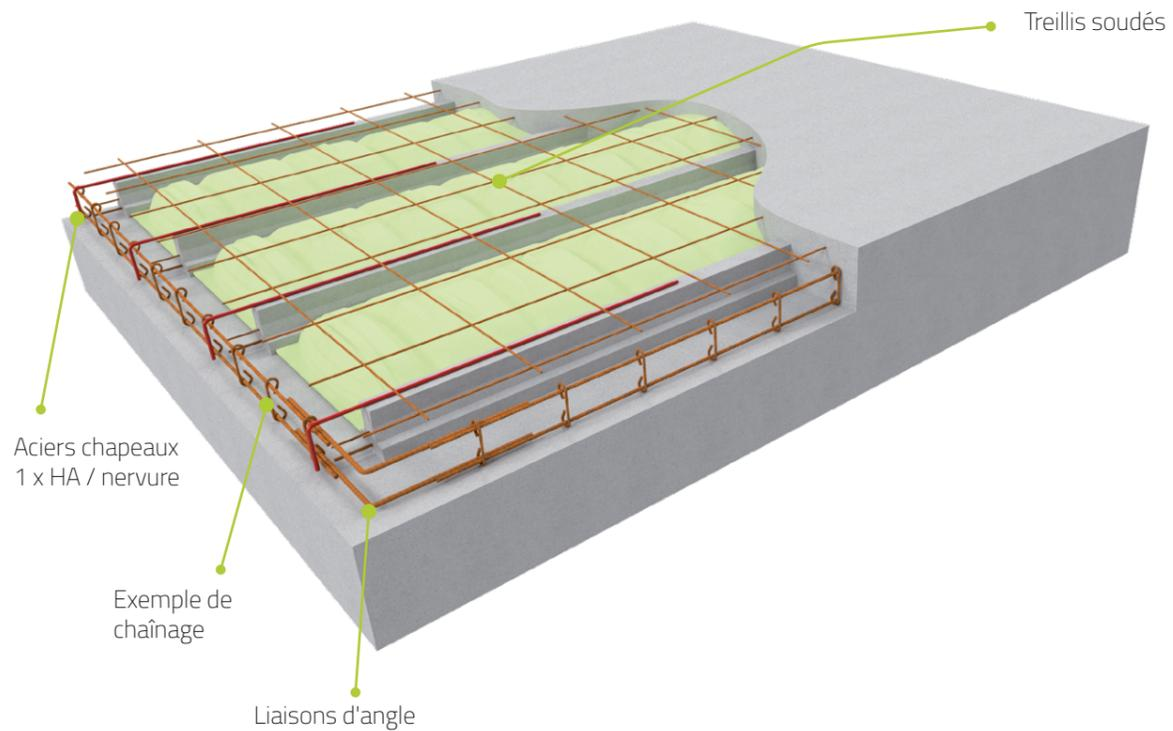
Le schéma ci-dessus représente les dispositions spécifiques relatives **sans l'utilisation de rupteurs thermiques** en zones sismiques 1 et 2.
