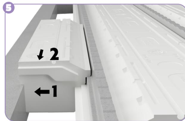
**TRAITEMENT DE LA DERNIÈRE TRAVÉE EN CAS DE FAUX-ENTRAXE :** découper les entrevous en respectant une distance d'appui minimum de 2 cm, puis les poser en respectant l'emboîtement. S'assurer de la sécurité lors de la pose en prenant les dispositions nécessaires (chemin de planches, garde-corps, port des Équipements de Protection Individuelle, etc.)
