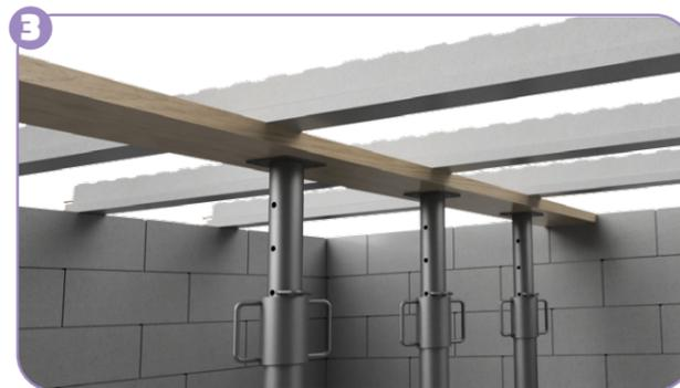
**3 POSE DES ÉTAIS** (selon dispositions du plan de pose). L'étalement doit être au contact de la poutrelle.
