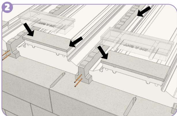
Poser les rupteurs feu en about et les fixer à l'aide de pointes d'ancrage dans la partie en polystyrène aux extrémités du rupteur.
