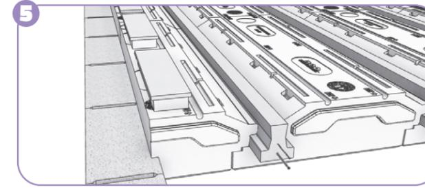
Retirer la partie sécable des rupteurs de rive et les poser sur la rehausse à 2 cm du bord de la partie découpée.
