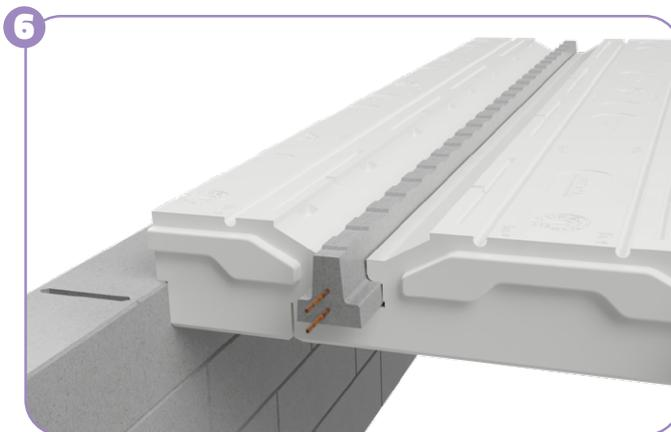
**DERNIÈRE TRAVÉE DANS LE CAS D'UN FAUX-ENTRAXE :** découper l'entrevous sur la longueur afin de conserver l'épaulement contre la poutrelle et les réservations spécifiques à l'emboîtement des rupteurs. Associer les deux parties de l'entrevous grâce aux connecteurs Fabrisol.
