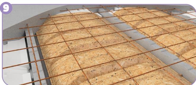
**FERRAILLAGE :** placer le treillis soudé, les aciers chapeaux et les armatures complémentaires selon les indications du plan de pose.
