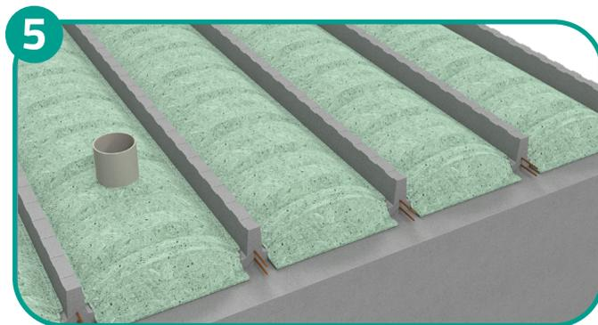
**PASSAGE DE CONDUITE DE CANALISATION :** percer l'entrevous au diamètre du tuyau d'évacuation
