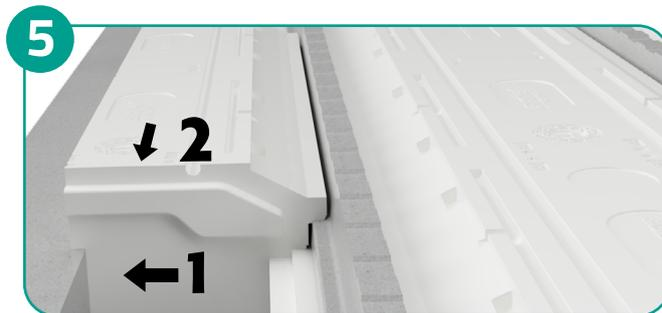
**TRAITEMENT DE LA DERNIÈRE TRAVÉE EN CAS DE FAUX-ENTRAXE** : découper les entrevous en respectant une distance d'appui minimum de 2 cm, puis les poser en respectant l'emboîtement. S'assurer de la sécurité lors de la pose en prenant les dispositions nécessaires (chemin de planches, garde-corps, port des Équipements de Protection Individuelle...).
