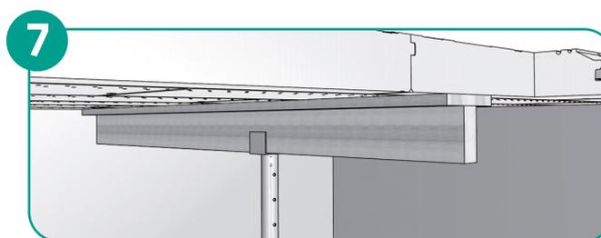
**POSE DES ÉTAIS** (selon dispositions du plan de pose) : pour protéger la sous-face des entrevous, placer une planche de largeur  $\geq 25$  cm entre le bastaing supérieur et la languette de l'entrevous.
