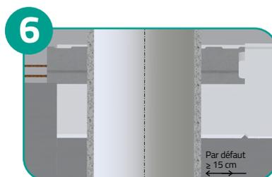
**PASSAGE ÉVENTUEL DE CONDUIT DE FUMÉE** : réaliser un dispositif d'écart au feu conforme aux préconisations du fournisseur et selon le DTU 24-1.
