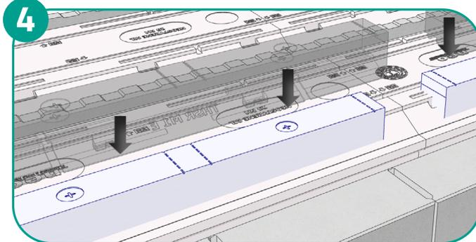
Poser les rupteurs en rive dans les rainures des Neostyrène et les fixer à l'aide de pointes d'ancrage.
