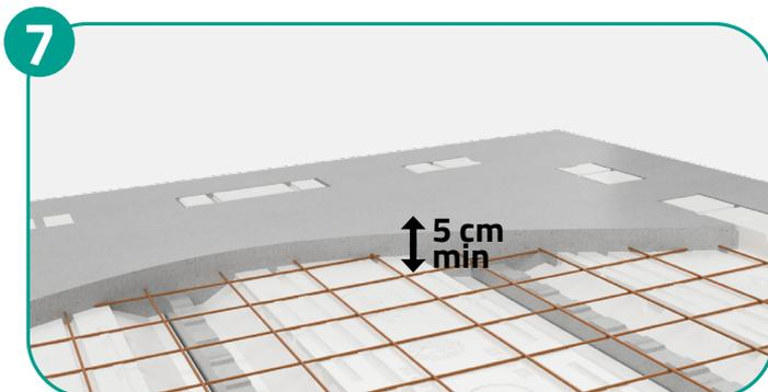
• **FERRAILLAGE** : placer le treillis soudé, les aciers chapeaux et les armatures complémentaires selon les indications du plan de pose. Se référer à la partie [Ferrailage p.3](#).
