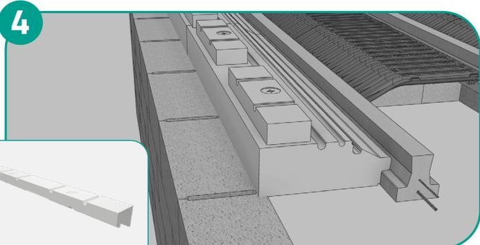
**EN CAS DE FAUX-ENTRAXE** : retirer la partie sécable des rupteurs de rive et les poser sur les Neostyrène Coffrant à 2 cm de la partie découpée. Les fixer à l'aide de pointes d'ancrage.
