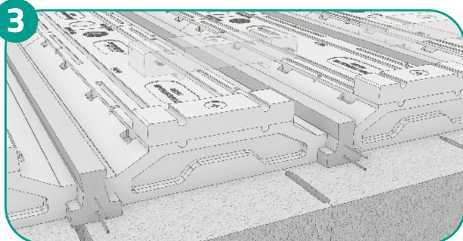
Poser les rupteurs en about et les fixer à l'aide de pointes d'ancrage.
