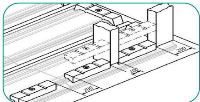
Poser les rupteurs en rive sur les Neostyrène Périf. Poser les rupteurs de rive en butée dans les rainures des Neostyrène Périf de manière à alterner des petits et grands espaces (calé à gauche, calé droite,...). Les fixer à l'aide de pointes d'ancrage.
