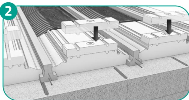
Poser les rupteurs en about sur les Neostyrène Périf et les fixer à l'aide de pointes d'ancrage.
