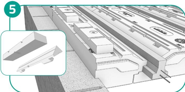
**EN CAS DE FAUX-ENTRAXE** : retirer la partie sécable des rupteurs de rive et les poser sur les Neostyrène à 2 cm de la partie découpée. Afin de respecter les espacements entre les rupteurs, les aligner par rapport aux nervures des Neostyrène. Les fixer à l'aide de pointes d'ancrage.
