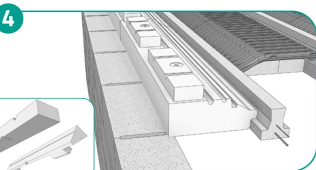
**EN CAS DE FAUX-ENTRAXE** : retirer la partie sécable des rupteurs de rive et les poser sur les Neostyrène Coffrant à 2 cm de la partie découpée. Les fixer à l'aide de pointes d'ancrage.
