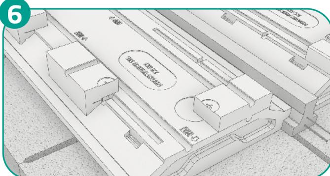
**DANS L'ANGLE** : disposer les rupteurs en fonction de la zone sismique. En zone 3 et 4, découper en deux les rupteurs.
