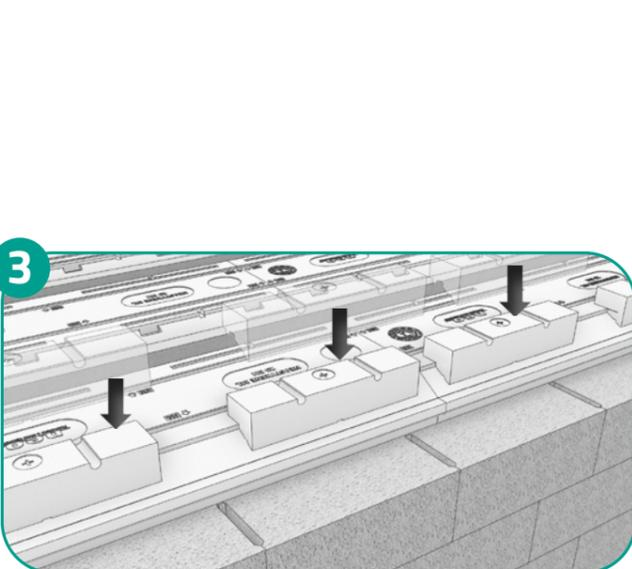
Poser les rupteurs en rive sur les Neostyrène Périf. Poser les rupteurs de rive en butée dans les rainures des Neostyrène Périf de manière à alterner des petits et grands espaces (calé à gauche, calé droite,...). Les fixer à l'aide de pointes d'ancrage.
