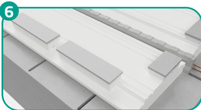
**DANS L'ANGLE :** découper en deux le rupteurs d'about.
