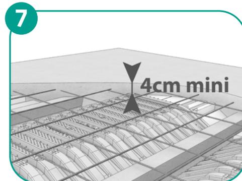
■ **FERRAILAGE** : placer le treillis soudé, les aciers chapeaux et les armatures complémentaires selon les indications du plan de pose.
