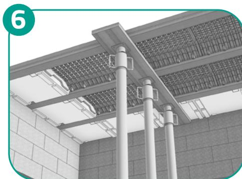
**POSE DES ÉTAIS** (selon dispositions du plan de pose) : l'étalement doit être au contact de la poutrelle.
