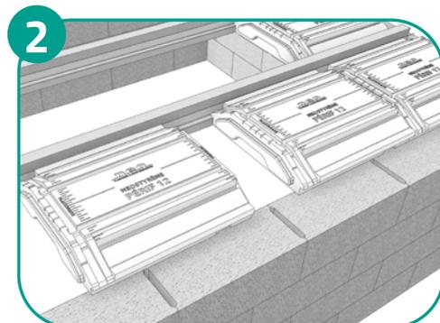
**POSE DES ENTREVOUS - TRAVÉE DE RIVE (1<sup>ÈRE</sup> TRAVÉE)** : poser les NEOSTYRENE PERIF sur toute la longueur de la travée en respectant l'emboîtement. En fin de travée, découper si besoin le dernier NEOSTYRENE PERIF afin d'ajuster sa longueur.
