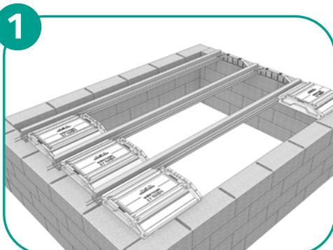
**RÉALISER L'ENTRAXE DES POUTRELLES** : poser sur la première travée de rive un NEOSTYRENE PERIF à chaque extrémité de la travée. **POUR LES TRAVÉES SUIVANTES** : démarrer la travée par un NEOSTYRENE PERIF (placer la partie correspondant à l'entrevous léger associé côté intérieur du plancher) et poser un obturateur Plastivoute ou Fabribois côté mur extérieur.
