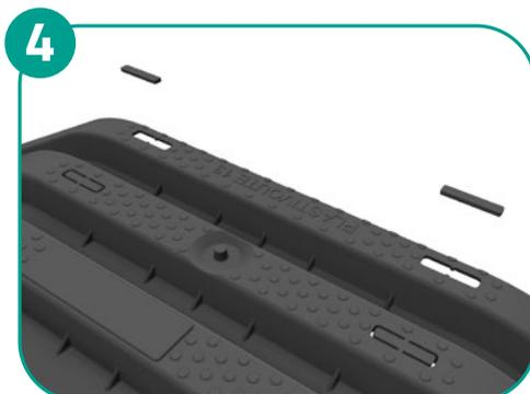
Détacher les réservations prédécoupées sur la dernière nervure en partie haute pour que l'obturateur coiffe et se clipse au-dessus de l'entrevous démodulé. La partie coupée restante de l'entrevous peut être utilisée pour démarrer la travée suivante.
