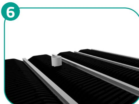
**PASSAGE ÉVENTUEL DE CONDUIT DE FUMÉE** : réaliser un dispositif d'écart au feu de 15 cm minimum, selon les préconisations du DTU 24-1.
