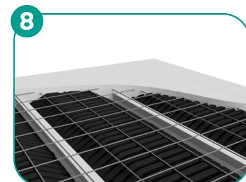
• **FERRAILAGE** : placer le treillis soudé, les aciers chapeauxnet les armatures complémentaires selon les indications du plan de pose.
