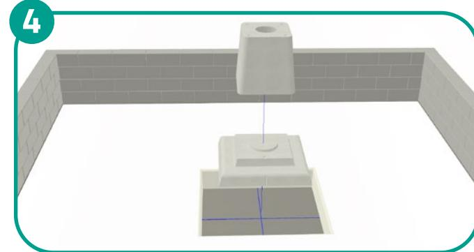
**TRACER LES AXES** de la semelle au cordeau sur le béton de propreté (voir plan de pose Neo). Il faut au moins 3 côtés pour mettre en œuvre la semelle.
