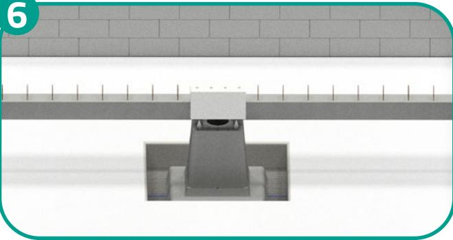
Insérer les **Connecteurs NEO dans les plots et les coffrages PSE** dans les Connecteurs NEO. Découper si besoin le coffrage afin de l'aligner à l'arase supérieure de la poutre.
