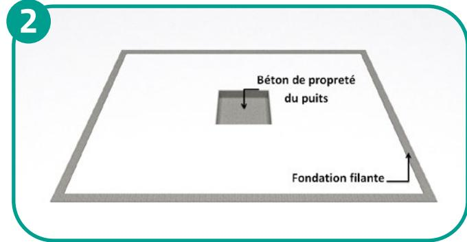
**RÉALISATION DU OU DES PUITS :** en fonction de votre plan de pose d'une dimension mini de 1 m 40 x 1 m 40. Le fond de fouille de chaque puit doit impérativement se situer à la même profondeur que la semelle filante en périphérie.
