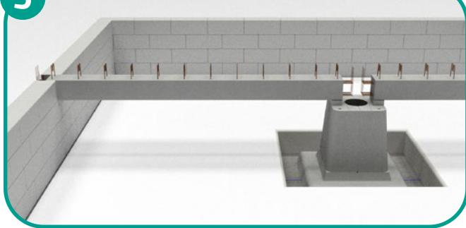
Si besoin et en fonction de votre configuration, **régler l'altimétrie grâce aux cales béton** (maxi 2 cales superposées). (Voir annexe Configurateur Refend). Dans le cas d'un montage poutre parpaing, insérer un lit de mortier entre les deux de 7 cm minimum.
