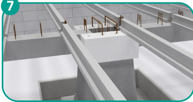
Dans le cas d'une mise en œuvre avec un entrevous sans languette, s'assurer du maintien du **coffrage PSE** en partie supérieure afin de maintenir l'étanchéité lors du coulage.
