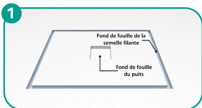
**RÉALISATION DU OU DES PUIITS** : en fonction de votre plan de pose d'une dimension mini de 1 m 40 x 1 m 40. Le fond de fouille de chaque puit doit impérativement se situer à la même profondeur que la semelle filante en périphérie.
