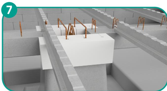
Dans le cas d'une mise en œuvre avec un entrevous sans languette, s'assurer du maintien du **coffrage PSE** en partie supérieure afin de maintenir l'étanchéité lors du coulage.
