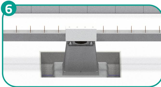
Insérer les **Connecteurs NEO** dans les plots et les coffrages PSE dans les Connecteurs NEO. Découper si besoin le coffrage afin de l'aligner à l'arase supérieure de la poutre.
