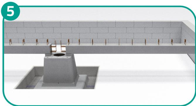
Si besoin et en fonction de votre configuration, **régler l'altimétrie grâce aux cales béton** (maxi 2 cales superposées). (Voir annexe Configurateur Refend). Dans le cas d'un montage poutre parpaing, insérer un lit de mortier entre les deux de 7 cm minimum.
