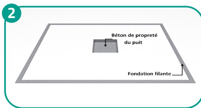
**COULAGE DU BÉTON DE PROPRETÉ** : respecter la différence de niveau notée sur l'annexe du Configurateur Refend (différence entre le dessus de la fondation filante et le dessus du béton de propreté).
