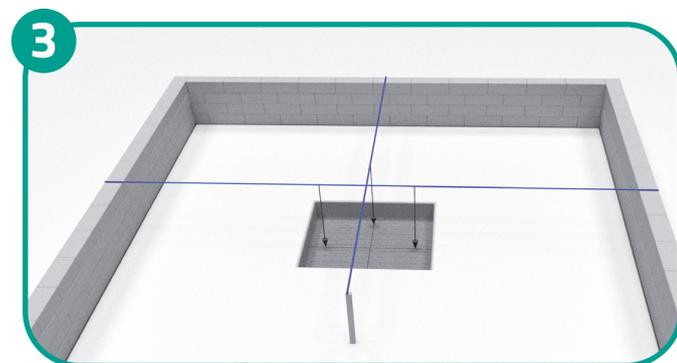
**TRACER LES AXES** de la semelle au cordeau sur le béton de propreté (voir plan de pose Neo). Il faut au moins 3 côtés pour mettre en œuvre la semelle.
