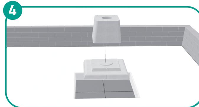
Si la portée de la grue le permet, **installer la semelle, puis le plot**. Sinon, poser les 2 éléments séparément. Afin de faciliter la mise en œuvre, utilisez le gabarit de pose.
