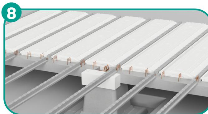
Poser le plancher suivant le plan de pose. Au niveau du clavetage, la poutrelle se pose sur le **coffrage PSE** sans disposition particulière. Coulage du plancher, clavetage des poutres et remplissage des plots se font en une seule opération.
