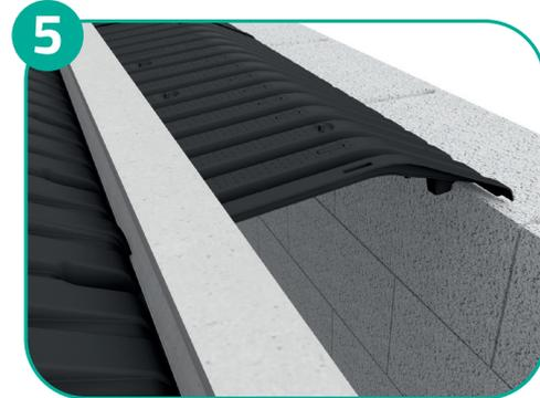
**DANS LE CAS D'UN FAUX-ENTRAXE** : découper l'entrevous dans le sens de la longueur. Dans le cas d'un faux-entraxe contre un mur, poser le côté découpé contre une poutrelle et les butées du côté du mur afin d'éviter le glissement de l'entrevous.
