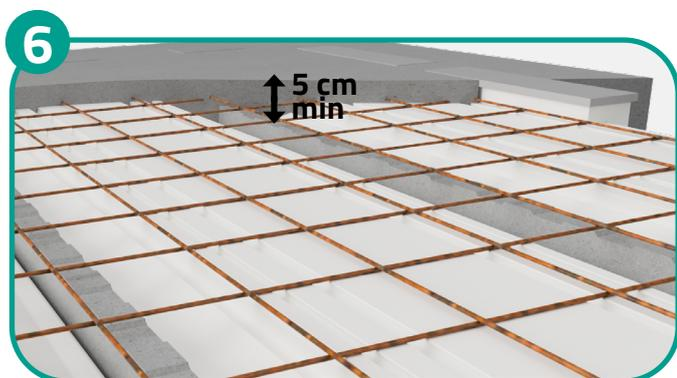
**FERRAILLAGE :** placer le treillis soudé, les aciers chapeaux et les armatures complémentaires selon les indications du plan de pose.
