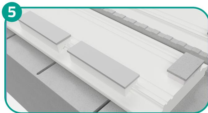
**DANS L'ANGLE :** découper en deux le rupteur d'about.
