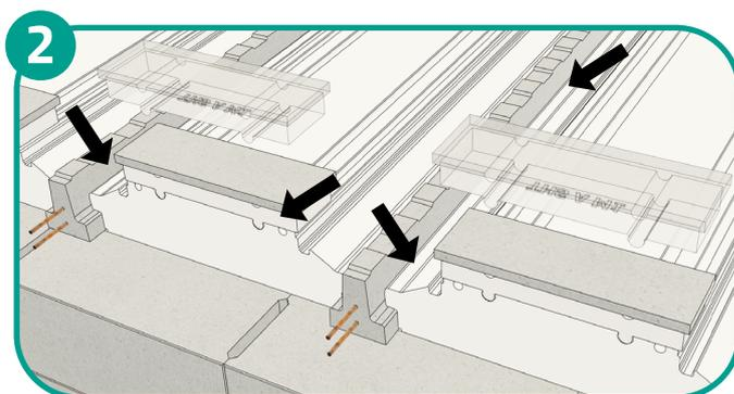
Poser les rupteurs feu en abut et les fixer à l'aide de pointes d'ancrage dans la partie en polystyrène aux extrémités du rupteur.
