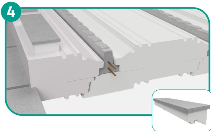
**EN CAS DE FAUX-ENTRAXES :** retirer la partie sécable des rupteurs de rive et les poser sur les Neostyrène Coffrant à 2 cm de la partie découpée.
