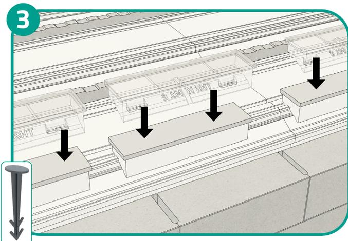
Poser les rupteurs en rive sur les Neostyrène Coffrant. Démarrer la pose des rupteurs de rive à 20 cm de l'extrémité de l'entrevous puis alterner un espacement entre rupteurs de 10 cm et 20 cm à l'aide des cales en polystyrène présentes sur les palettes. Les fixer sur les côtés à l'aide de pointes d'ancrage.
