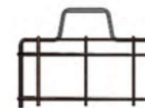
Cage d'armatures intégrée à la fabrication du plot
